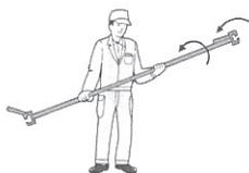
**2** 水平布材を回転させてクサビが寝るようにします。
