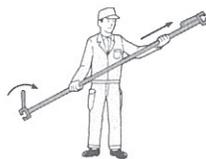
**3** 水平布材を高い方に動かして、低い方のクサビも寝るようにします。
